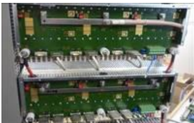
Bild 3: Hochstromleiterplatte der Backplane mit Einpresskontakten
