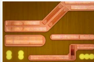
Profile verschiedener Breite (2, 4, 8, 12 mm x 0,5 mm)
